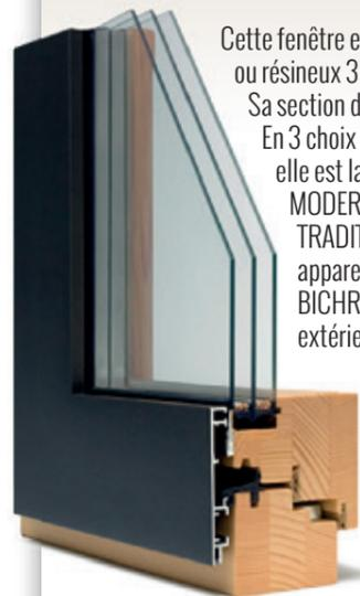
Cette fenêtre est construite en épicea ou résineux 3 plis, 1<sup>er</sup> choix. Sa section de cadre mesure 80 x 68 mm. En 3 choix de finition, elle est lasurée en ton bois ou coloris RAL. MODERNE : lasurée opaque TRADITIONNELLE : lasurée, veinage apparent BICHROMIQUE : 1 ton intérieur et 1 ton extérieur.
